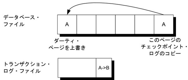
2. **チェックポイント以降に加えられた変更を適用する** チェックポイントからシステム障害が発生するまでの間に加えられた変更が適用されます。この変更内容はトランザクション・ログに格納されています。
