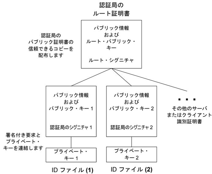
dbsrv10 または mlsv10 コマンド・ラインで、サーバ ID ファイルと、プライベート・キーのパスワードを参照します。
